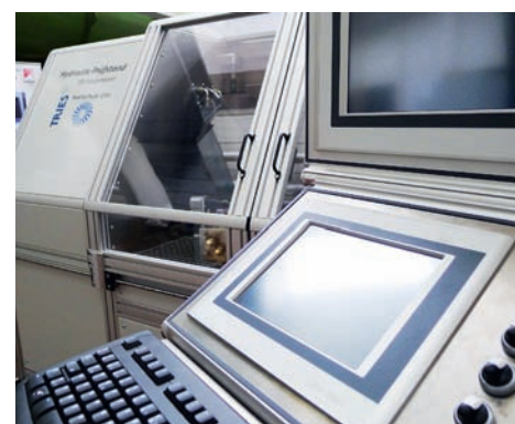
Im Maschinenlabor komplettiert ein Ventilprüfstand, gestiftet von der Firma Tries, den Maschinenpark.
